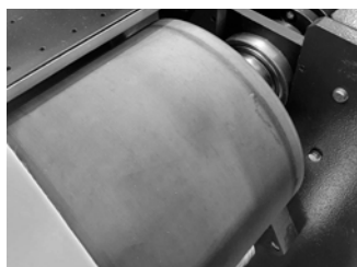
Alimentazione con rullo in gomma (niente pinch-roller)
